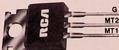
Fig. 1. Principe van de fase-aansnijding. De afb. geeft aan, hoe de elektroden van de triac in werkelijkheid zijn benoemd.
