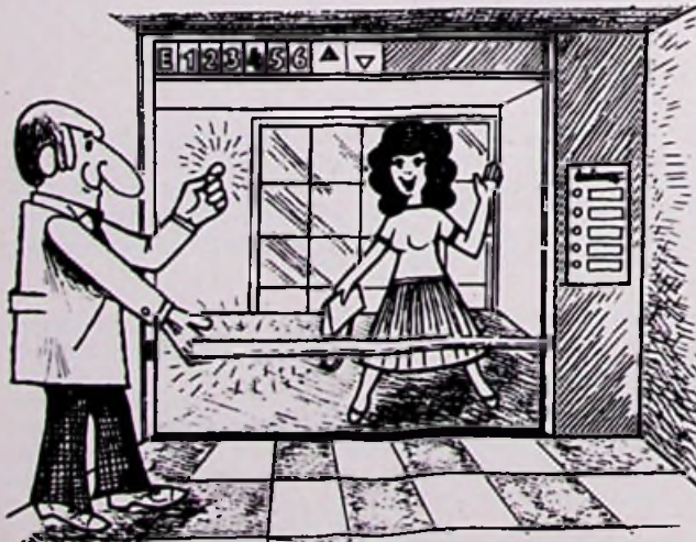
Liftdeuren sluiten niet als iemand de straal van de lichtbank onderbreekt.
