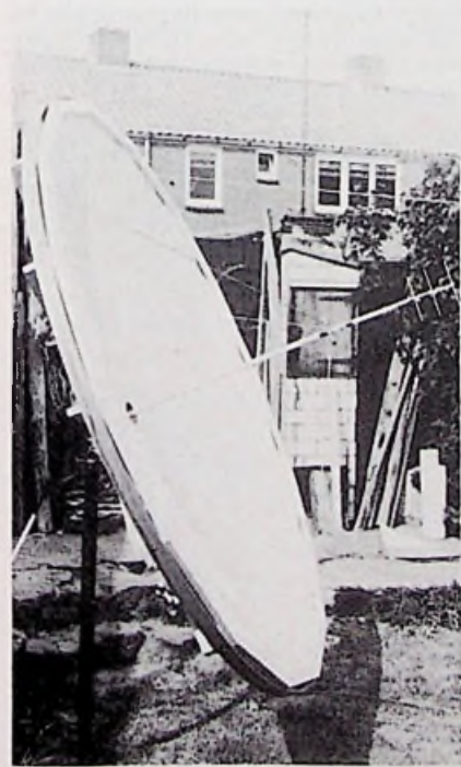
Afb. 1. Opstelling van de parabolantenne in de tuin. De diameter bedraagt 2 m en de elevatiehoek is 25 graden. De antenne versterkt ca. 22 dB bij 860 MHz; de brandpuntsafstand is 1 m.
